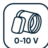
ВОЗДУШНАЯ ЗАСЛОНКА С УПРАВЛЕНИЕМ 0-10 V
