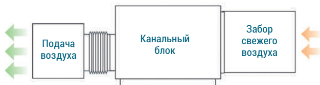
Схема подачи свежего воздуха канальным высоконапорным блоком
