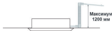
Мощность напора дренажного насоса — 1,2 м
