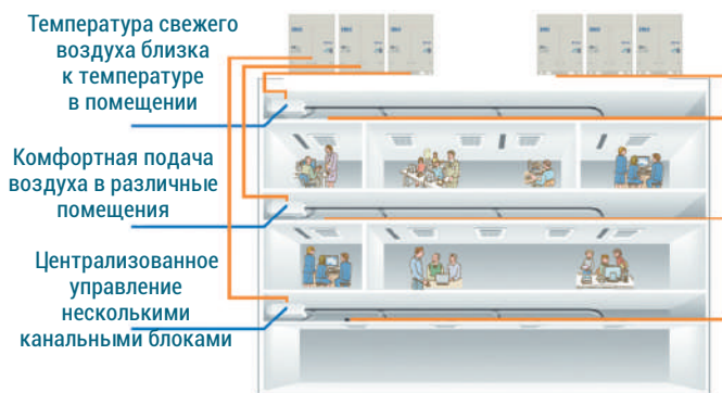
Многопоточная подача воздуха канальными блоками
