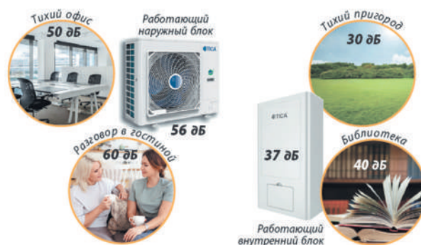
Уровень шума во время эксплуатации теплового насоса
