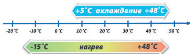
Диапазон рабочих температур стандартных модульных чиллеров (тепловых насосов) серии TCA
