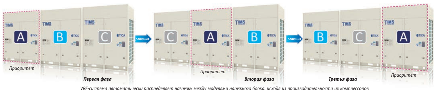
VRF-система автоматически распределяет нагрузку между модулями наружного блока, исходя из производительности их компрессоров
