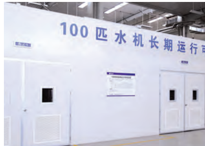
Стенд для длительного тестирования HVAC-оборудования производительностью до 110 кВт
