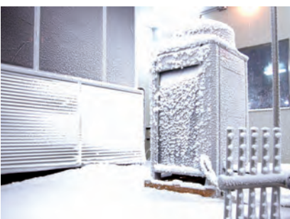
Лаборатория, симулирующая эксплуатацию оборудования в заснеженных условиях. Диапазон температур составляет от -40 до +55 °C
