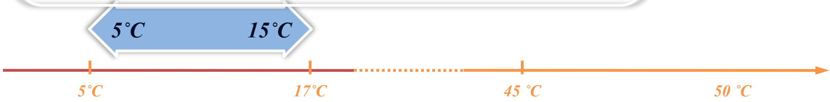
Диапазон температур охлажденной воды на выходе чиллера
