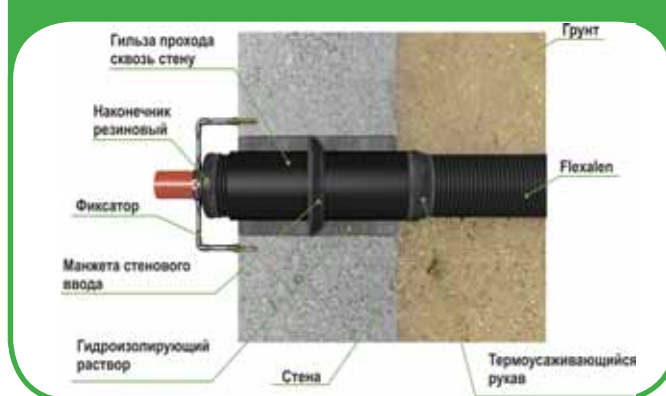
4. Проход сквозь стену FD-MD...DRS
