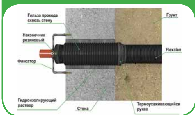
3. Проход сквозь стену FD-MD...
