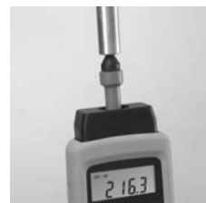
Механическое измерение с наконечником зонда
