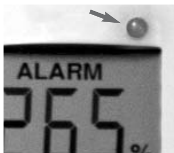
Точные показания, сигнал в случае превышения допустимого интервала значений
