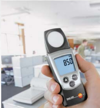
Измерение интенсивности освещенности на рабочих местах
