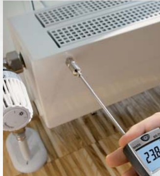
Измерения поверхностной температуры радиатора
