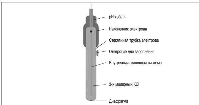
Рис. 8: Конструкция электрода сравнения
