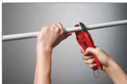
Отрезание трубы при помощи труборезных ножниц
