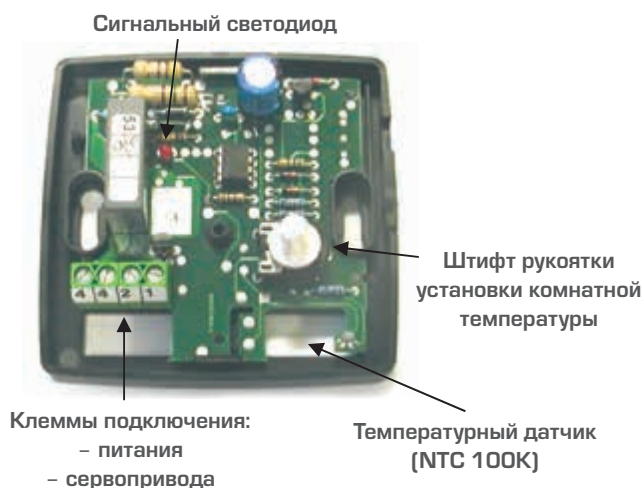
Рис. 12. Устройство электронного термостата для напольного отопления
