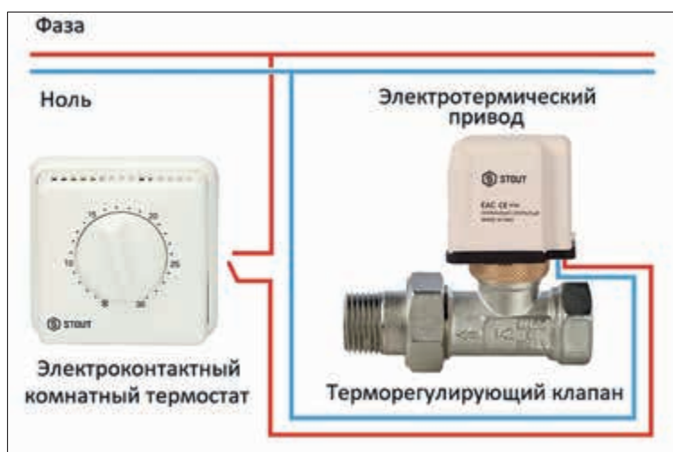
Рис. 3. Схема электрических соединений сети управления
