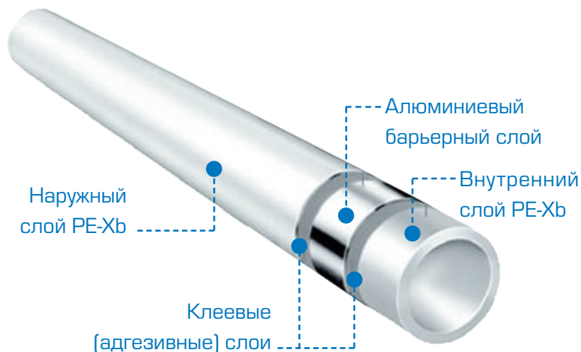
Рис. 5. Пятислойная металлополимерная труба PE-Xb/Al/PE-Xb
