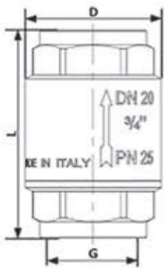
Рис. 32 Габаритные и присоединительные размеры обратного клапана с пластиковым затвором
