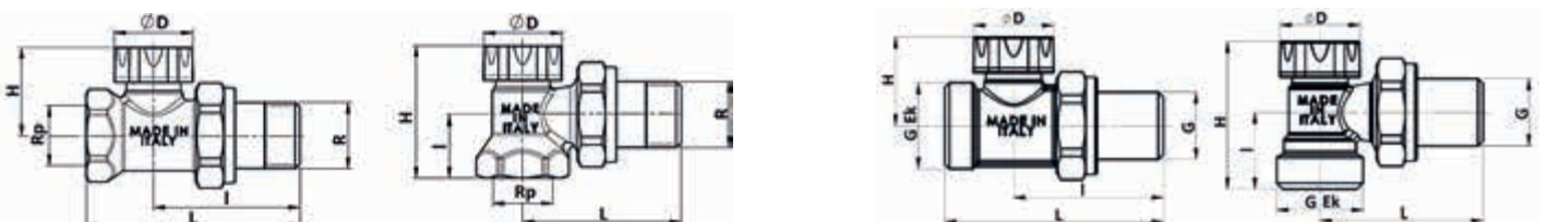
Рис. 31. Устройство запорно-балансировочного клапана типа SVL
