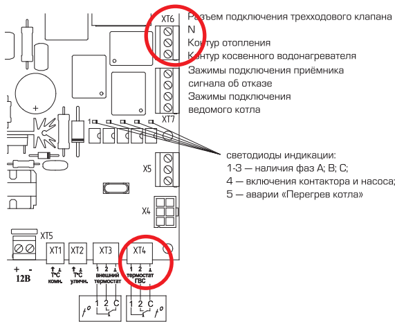
Рис. 13. Схема подключения датчика температуры бойлера
