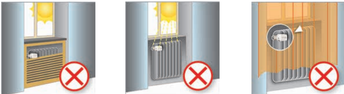
Рис. 8. Требования по размещению автоматического терморегулятора
