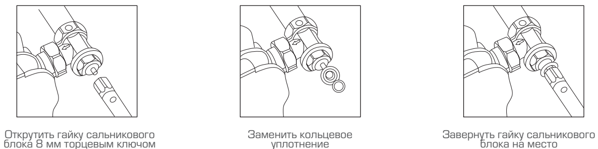
Рис. 21. Замена кольцевого уплотнения штока клапана терморегулятора
