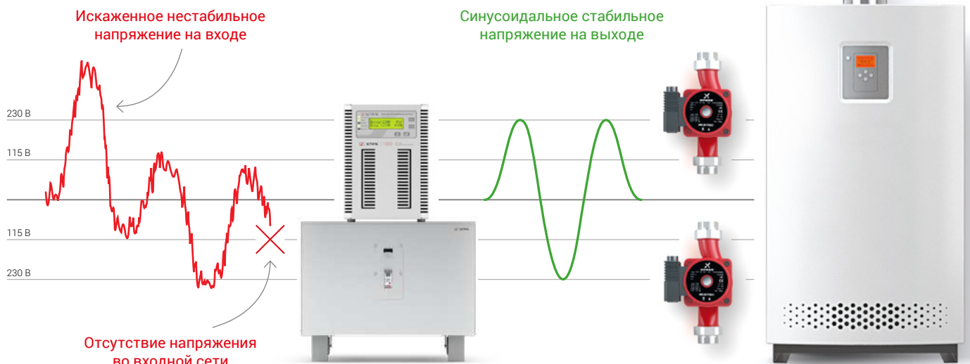
ИБП ST1101L с батарейным стеллажом BS-01
