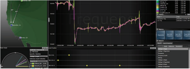
СИСТЕМА РЕГИСТРАЦИИ ДИНАМИЧЕСКИХ НАРУШЕНИЙ И АВАРИЙНЫХ ПРОЦЕССОВ
