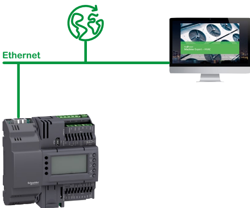
Логические контроллеры M172 Optimized, подключенные к Ethernet через коммуникационный модуль TM171AETH или TM171AETHRS485
