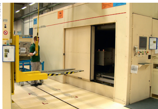
Приемо-сдаточные испытания на герметичность
