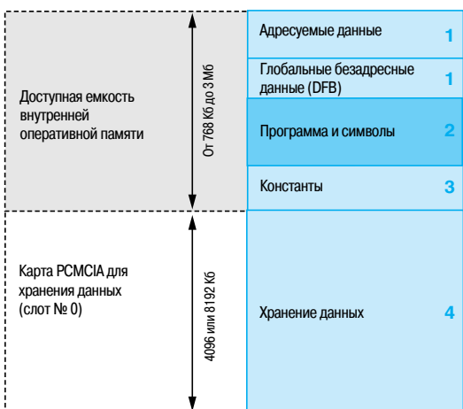
ЦП с картой памяти PCMCIA для хранения данных, установленной в слот № 0
