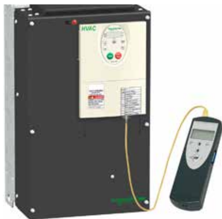
Конфигурирование преобразователя частоты Altivar 212 при помощи Мультизагрузчика
