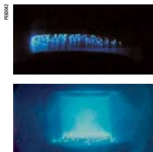
Рис. 3. Распределение дуги в вакууме в условиях аксиального магнитного поля
