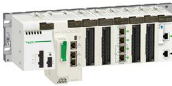
Платформа ввода/вывода Modicon X80 с процессором M580
