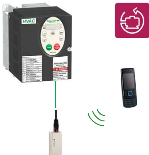
Конфигурирование преобразователя частоты Altivar 212 при помощи программного обеспечения SoMove Mobile, разработанного для мобильных телефонов, используется беспроводное соединение Bluetooth®
