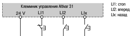
Схема соединений при 3-проводном управлении
