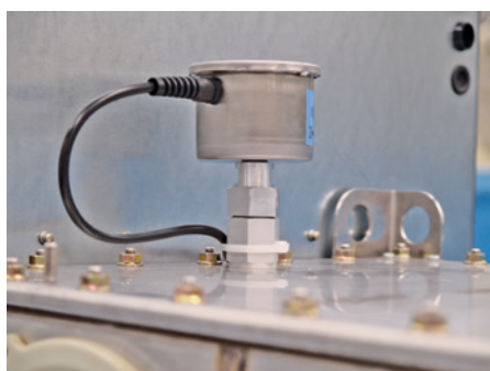
Датчик давления, монтируемый через клапан
