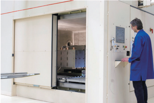
Испытание на утечку элегаза для ячейки
