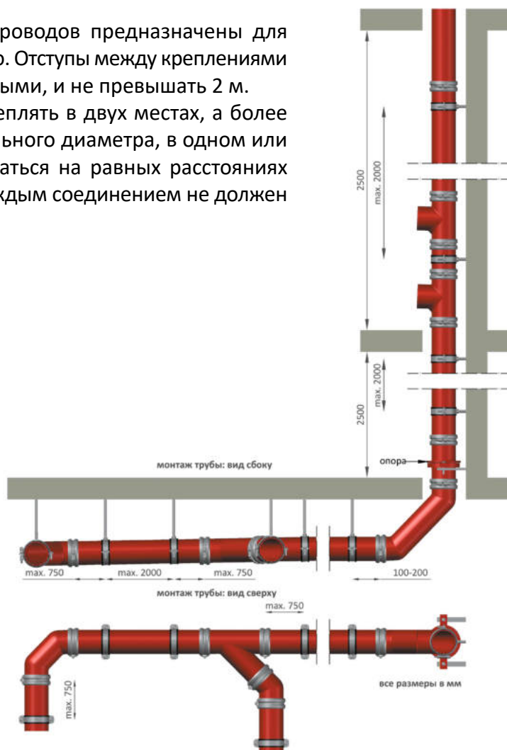
Общая схема монтажа системы Sanline SML
