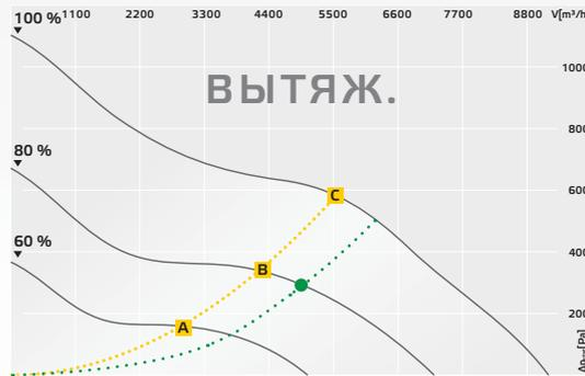
Выберите последующую эксплуатационную точку вентиляционной установки. Напр. объемный поток воздуха 5.000 м³/ч потеря давления в канале Δp<sub>stat</sub> 250 Па.
