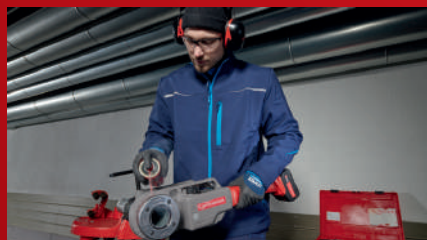
Крепление Speed-Lock (быстродействующее) для монтажа резьбонарезных головок без использования инструмента
