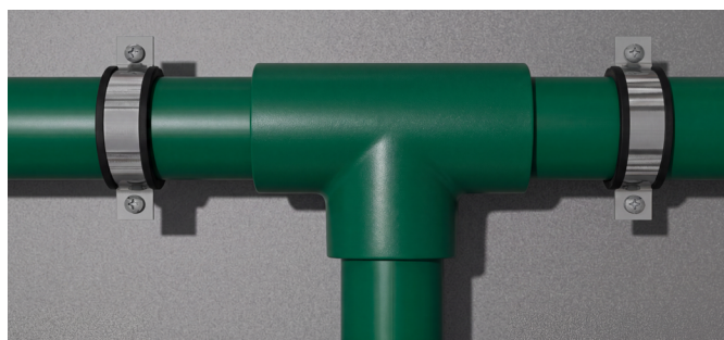
В местах ответвления трубопровода
