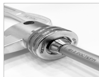
3. Проведите экспандирование трубы РЕ-Х в три этапа (30%, 70%, 100%), между этапами проворачивая экспандируемую трубу на 30° вокруг своей оси
