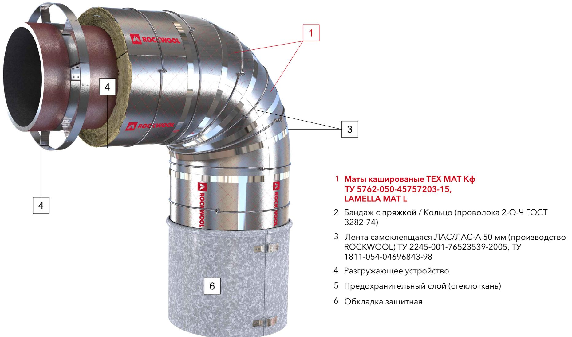
А1.28 Тепловая изоляция отводов трубопроводов  $d_n$  от 273 до 1420 мм с отрицательными температурами теплоносителя матами минераловатными ROCKWOOL
