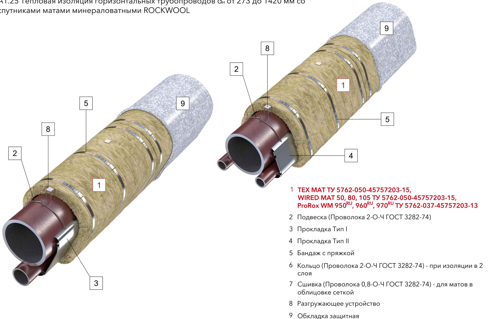
А1.25 Тепловая изоляция горизонтальных трубопроводов  $d_n$  от 273 до 1420 мм со спутниками матами минераловатными ROCKWOOL
