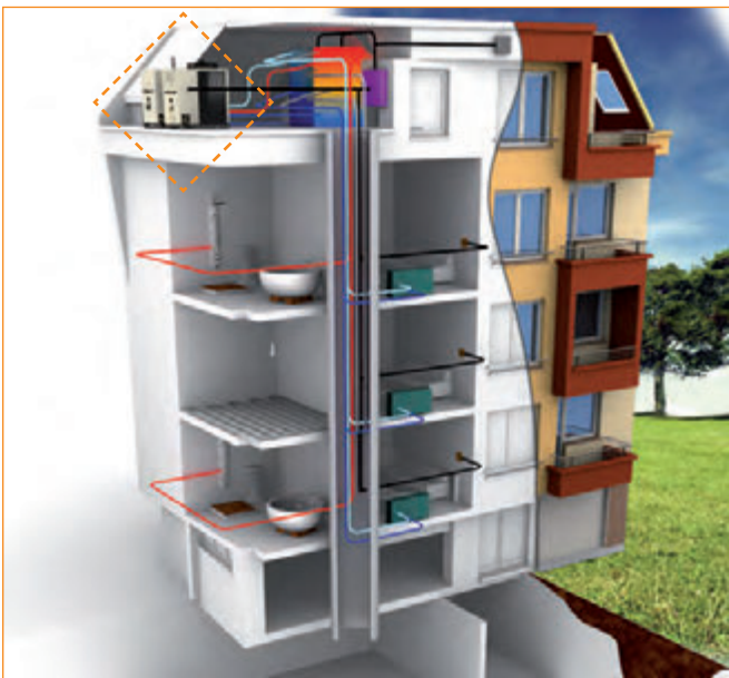
Примеры использования ТН летом и зимой с теплыми полами, фанкойлами и косвенным нагревом ГВС.
