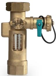
Für die korrekte Funktion einer Solaranlage ist es wichtig, dass der Volumenstrom stimmt. Die RESOL Volumenstromanzeige VM1020 zeigt zuverlässig Volumenströme zwischen 1 und 13 Litern pro Minute an, mit dem integrierten Durchflussmengenbegrenzer kann der Wert gedrosselt werden.
