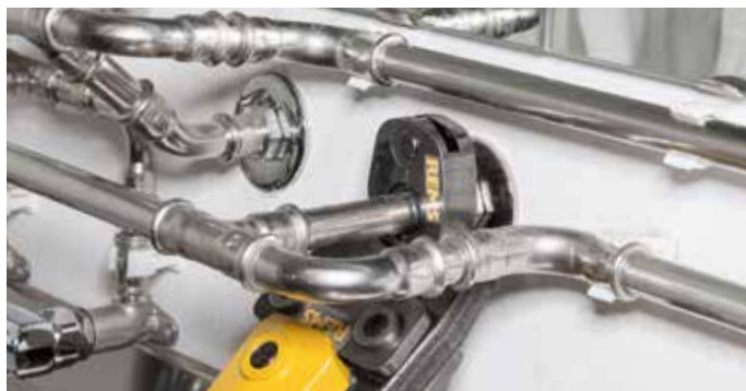
Пресс-шайба REMS 45° (PR-2B) с 2 щечками для запрессовки в труднодоступных местах, с промежуточным зажимом.
