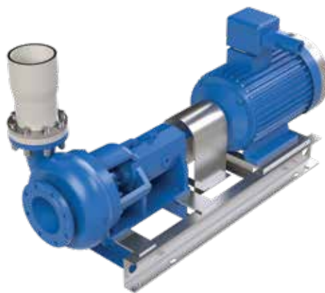
Соединение с нагнетательным патрубком шламового насоса через формованный переход МУЛЬТИПАЙП ИС, присоединенный к фланцу насоса через фланцевую втулку. Фланец нестандартный
