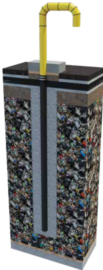
Пример обустройства скважины для пассивной дегазации
