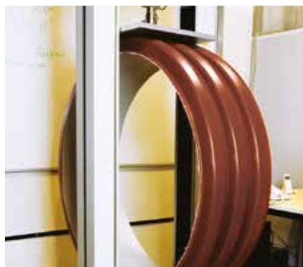
Рисунок 1. Кольцевая жесткость. Испытания в соответствии с ГОСТ Р 54475-2011 (п. 8.4), ТУ 22.21.21-078-73011750-2021 (п. 4.5)
