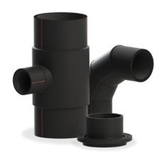
Литьевые фитинги для труб серии МУЛЬТИТЕРМ изготавливаются из полиэтилена повышенной термостойкости PE-RT тип II методом литья под давлением с возможной последующей механической обработкой.
