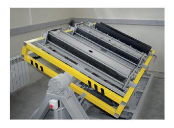
Суть метода состоит в измерении величины износа отрезка полимерной трубы смесью воды и крупных абразивных частиц (средний размер 6 мм). Движение смеси обеспечивается изменением наклона образца на ± 22,5° с частотой 20 циклов в минуту.
