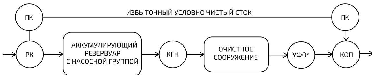
Однолинейная накопительная схема очистного сооружения ПОЛИПЛАСТИК.
