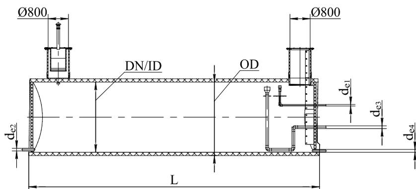
DN/ID – внутренний диаметр корпуса, мм
