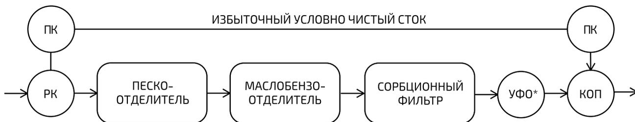
Однолинейная проточная схема очистного сооружения ПОЛИПЛАСТИК.
