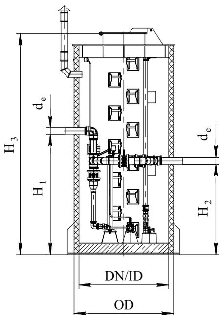
DN/ID – внутренний диаметр корпуса, мм
