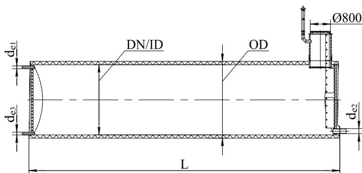
DN/ID – внутренний диаметр корпуса, мм
