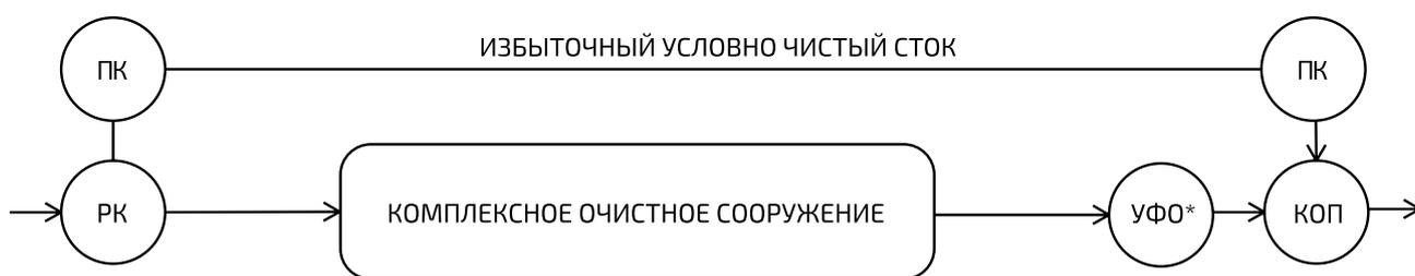
Однолинейная проточная схема очистного сооружения ПОЛИПЛАСТИК в одном корпусе.
