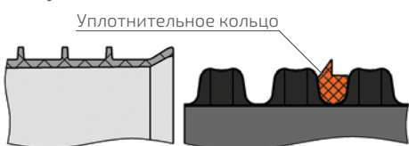
Рисунок А. Установка уплотнительного кольца для труб DN 250–1200 мм
