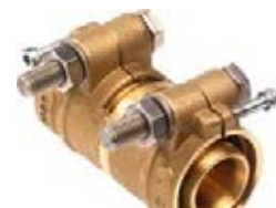
Соединительный фитинг для прямого соединения 2-х концов РЕ-Х труб SDR 11
