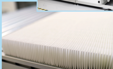
Плиссировка фильтрующего материала из стекловолокна
