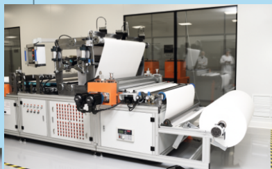
Плиссировка фильтрующего материала из стекловолокна
