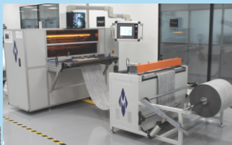
Плиссировка синтетических материалов, включая угольный фильтрующий материал
