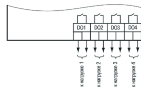
Схема подключения нагрузки к ВЭ типа «Р»
