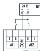
Схема подключения к универсальным входам, работающим в дискретном режиме датчиков типа «сухой» контакт
