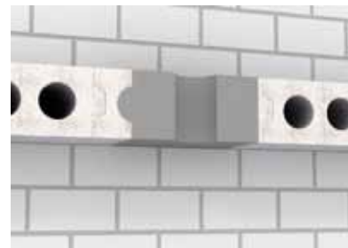
Перекрытие из пористого бетона (возможно с пустотами)
