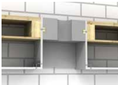
Перекрытие с деревянными балками с подшивным потолком
