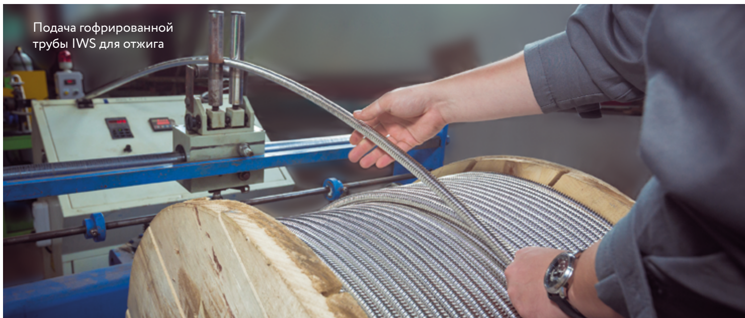
Линия охлаждения гофрированной трубы IWS после отжига
