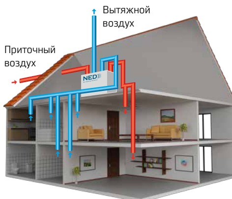
Схема работы установки MININED в жилом помещении
