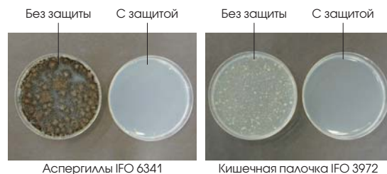
Результаты испытаний, проведенных в исследовательской лаборатории MHI (слева – количество бактерий, находящихся на поверхности вентилятора, справа – количество бактерий через 24 ч).
