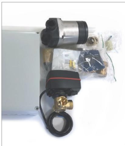
**Смесительный узел для точной регулировки температуры воды в разных отопительных системах** (например, в системе радиаторов и «теплых полов»). ECS40M рассчитан на площадь «теплых полов» максимум 80м<sup>2</sup>, ECS41M рассчитан на площадь «теплых полов» в 80-250 м<sup>2</sup>. Общий расход воды не должен превышать 1700 л/ч.
