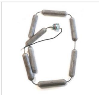
**Цепь магниевых анодов.** Магниевый анод предотвращает коррозию в баке-аккумуляторе. Рекомендованный период использования между заменой - 18 мес.
