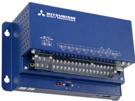
Шлюз SC-WBGW256 с помощью ПК управляет и контролирует до 256 групп (некоторые группы могут содержать несколько блоков, но общее количество внутренних блоков должно быть не более 256), преобразуя сигнал Superlink-II в Web-управление. Для установки не нужны специальные системные требования (управление через Internet Explorer).
