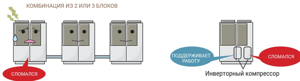
В случае, если один из блоков в рамках комбинаторной системы выйдет из строя, остальные распределят его нагрузку между собой.
