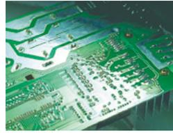
Плата микропроцессора защищена специальным силиконовым слоем, обеспечивающим защиту от влаги и большой срок службы.
