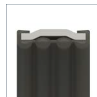
Валикообразный профиль изолирующей вставки
