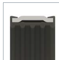
Валикообразный профиль изолирующей вставки
