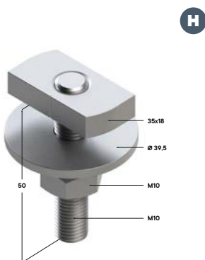
Болт Т-образный усиленный 41 8F
