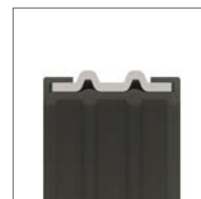
Валикообразный профиль изолирующей вставки
