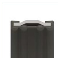
Валикообразный профиль изолирующей вставки
