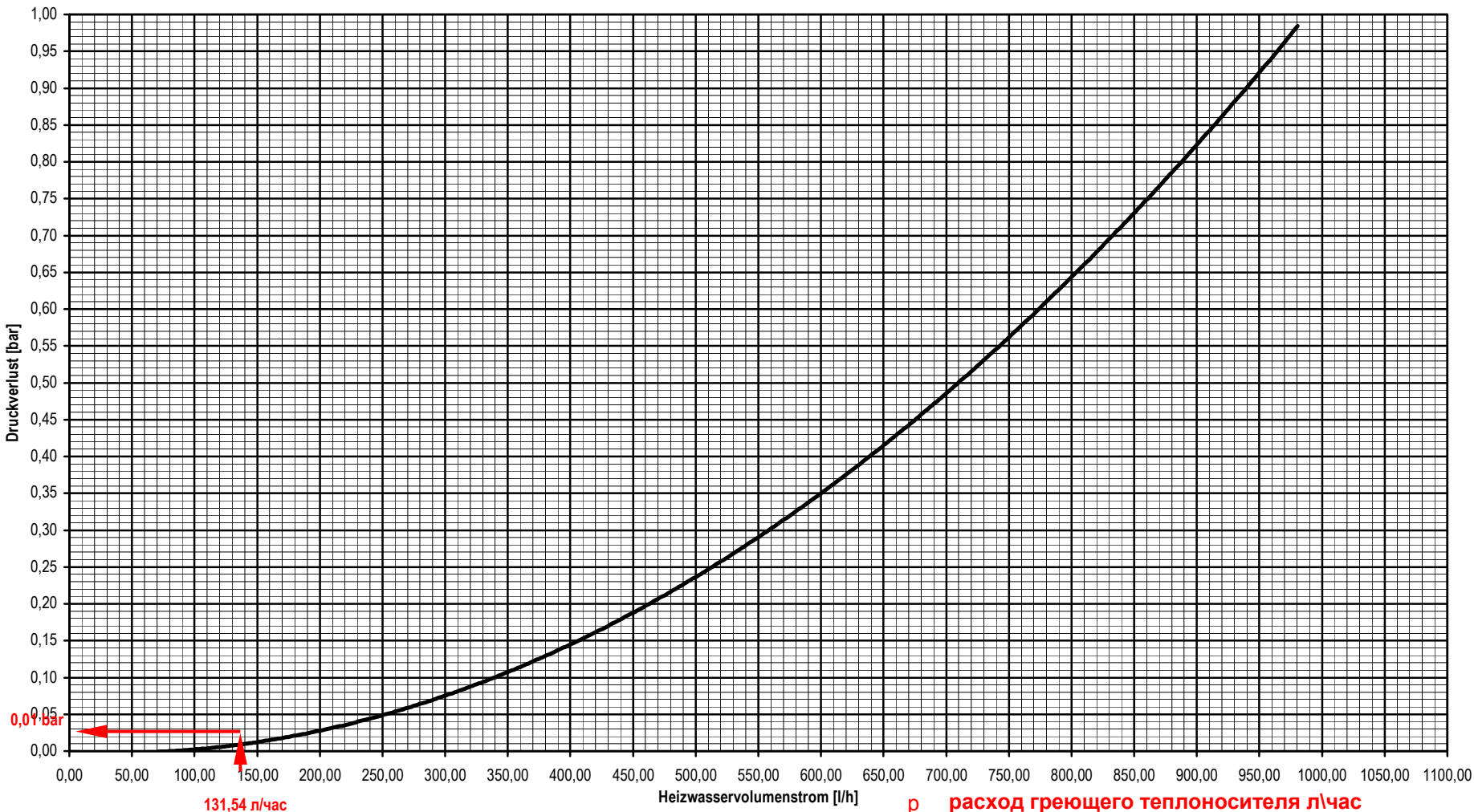
Logotherm Modulsystem Druckverlust der Geräte-Heizungsseite in Abhängigkeit des Heizwasservolumenstromes Grundmodul (Zonenventil voll geöffnet)
