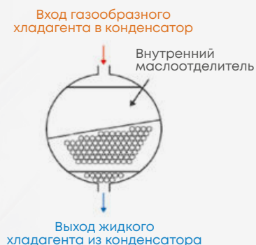
Встроенный маслоотделитель конденсатора
