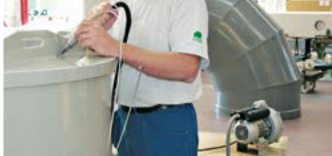
Вентилятор ROBUST подаёт воздух к WELDING PEN
