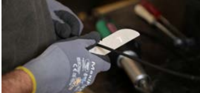
Удаление оксидного слоя со сварочного прутка
