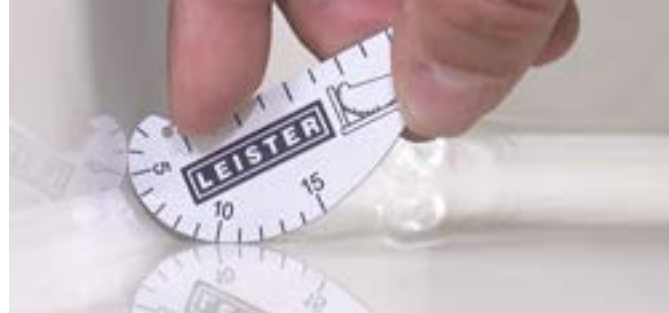
Удобно контролировать размер сварочного шва
